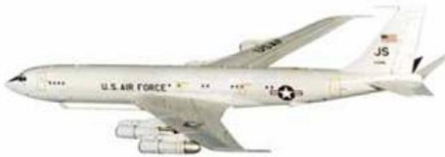
J-STARS(조인트 스타즈)는 통합 감시 목표공격 레이더 시스템 (Joint Surveillance and Target Attack System)의 줄임말로써 J는 미 육군과 공군의 합동 프로그램을 뜻하고 있다. E-3 AWACS (공중경보통제기)가 공중 목표를 탐지하는 것과 달리 E-8은 지상전에서 전투지역 감시 및 목표의 수색, 공격 유도, 추전 감시 등을 맡고
