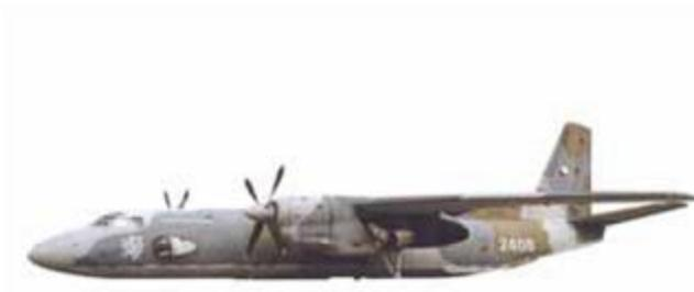
AN-24는 구형 쌍발 왕복엔진 수송기를 대체하기 위하여 개발된 단거리용 터보프롭 수송기로서 1963년부터 국내선의 주력 기종으로 사용되었다. 동급의 베스트셀러인 포커 F27과 쌍벽을 이루는 AN-24는 여객기형과 함께 화물기형인 AN-247이 개발되었으며 화물기형은 후방동체 아래에 카고도어와 탑재용 호이스트를 장비하였고 탑재화물의 공중투하도 가능하다. AN-24시리
