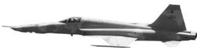
F-SE의 기수부를 개조하여 각종 정찰 장비를 탑재한 전술정찰기. 12대가 신규 생산되어 말레이시아 공군(2대)과 사우디아라비아 공군(10대)에 인도되었으며 90년대 말부터는 대만 공군과 싱가포르 공군을 위한 기체가 개조 생산방식으로 배치되고 있다. 싱가포르 기체는 RF-5S라고 부르며 대만 기체는 RF-5T라고 부른다. RF~5E의 특징은 정찰장비를 팔레트에 탑재하기 때
