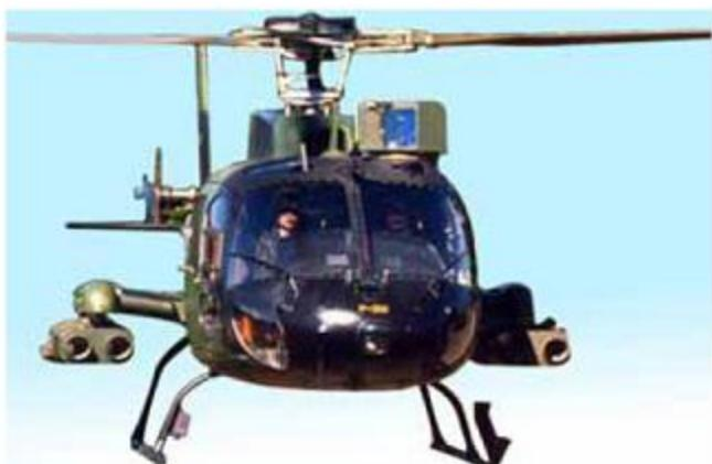
EC-650 / EC-555 페넥은 아에로스빠시알사가 전 세계에 대량으로 공급한 알루에트 II/III의 후계기로서 개발된 소형 터빈 헬기이다. 메인로터는 3엽의 복합소재 브레이드이고 테일룸도 복합소재를 대량으로 사용하는 등 많은 새로운 기술이 도입된 경량의 전투헬기이다.
