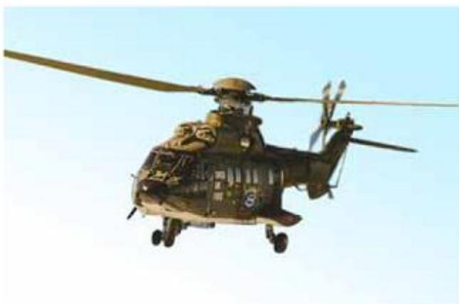
EC332/EC532는 AS330 퓨마로부터 발달한 터빈쌍발 대형 수송용 헬기이다. 기본구조는 AS330과 거의 변화가 없지만 고출력 엔진으로 교체하였기 때문에 기어박스와 복합소재 4엽 블레이드의 메인 로터와 5엽 블레이드의 테일 로터 등의 동력전달계통은 개량되었다.
